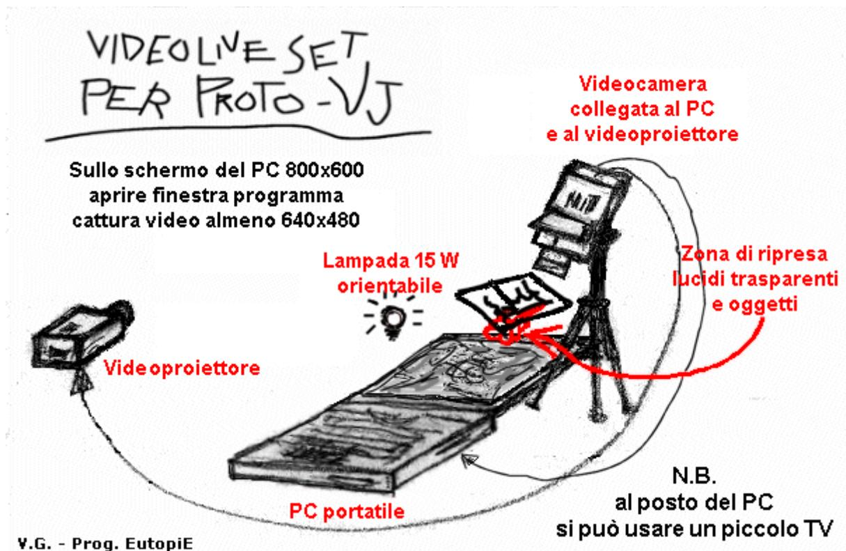
**Se si usa un portatile** la videocamera e il PC devono avere la presa Firewire per poterli collegare.
